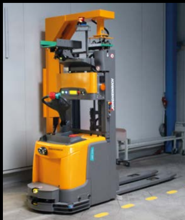
Teilautomatisierung des Materialflusses durch das Fahrerlose Transportsystem vom Typ ERC 215a.
